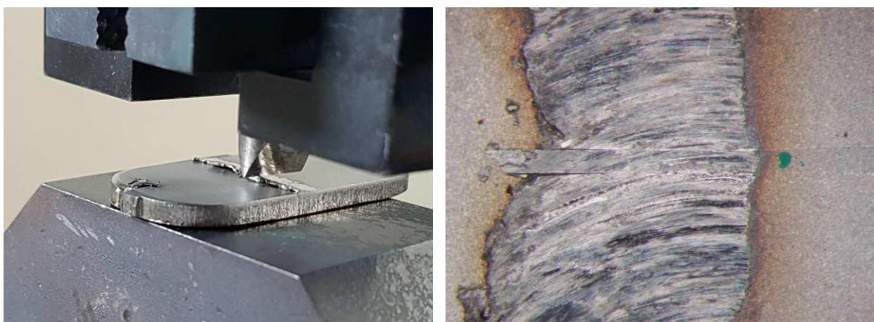
Abbildung 43: Haftfestigkeitsprüfung; links: Versuchsaufbau, rechts: Versuchsergebnis
