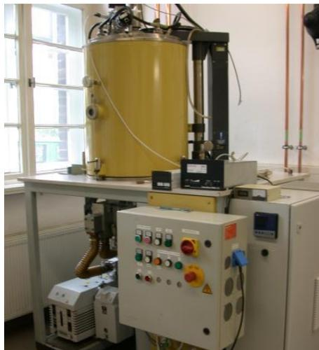
*Abbildung 15: Industrie-Vakuumofen Typ Tesla PZ 810*
