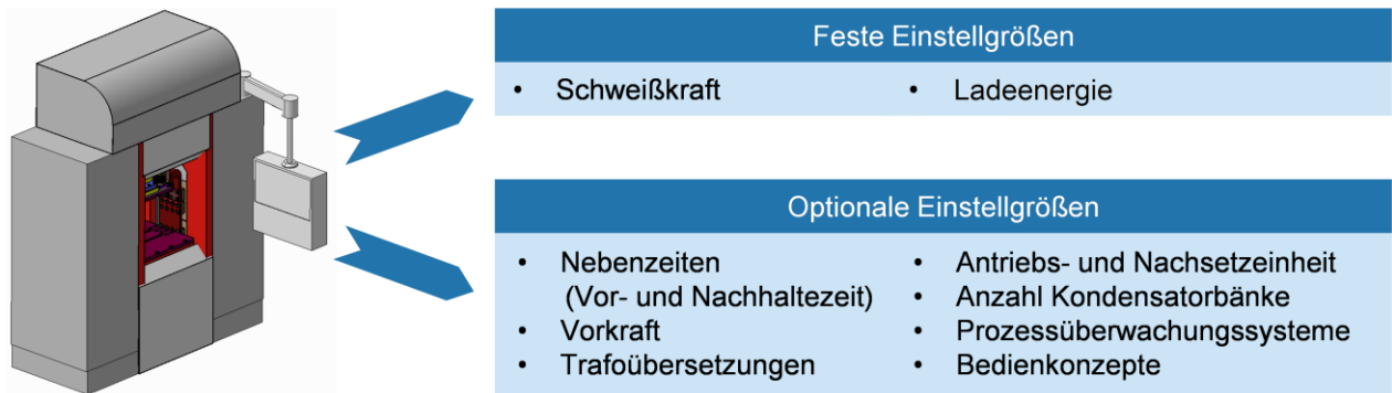
Abbildung 9: Einstellgrößen an einer Kondensatorentladungsschweißanlage [2]
