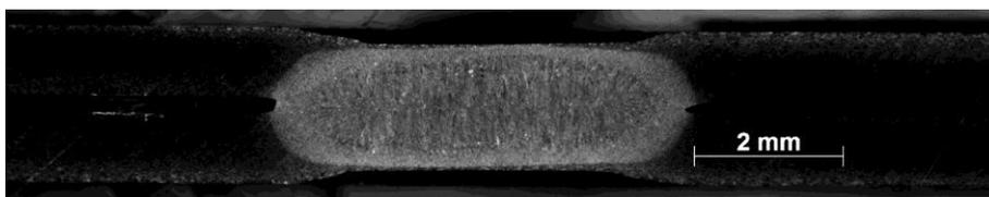
Abbildung 98: Querschliff der Schweißprobe 5M\_I7,2kA\_P0002,  $I_w = 7,2$  kA,  $F_e = 3,0$  kN,  $t_w = 480$  ms
