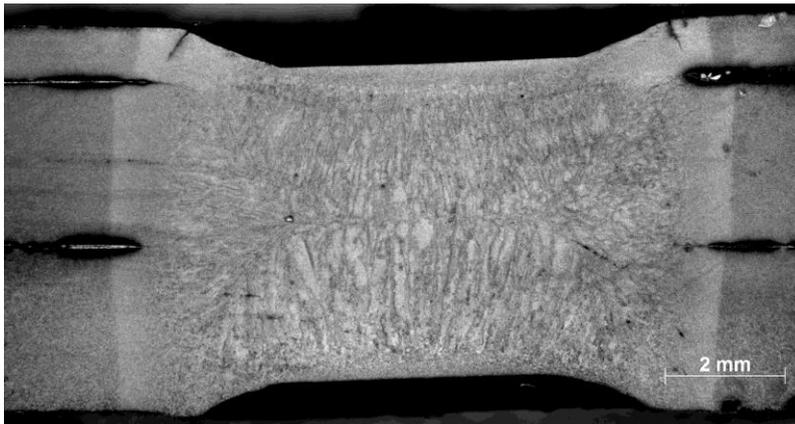
Abbildung 79: Querschliff der Schweißprobe 4M\_I11,6kA\_P0003,  $I_w = 11,6$  kA,  $F_e = 3,0$  kN,  $t_w = 1000$  ms
