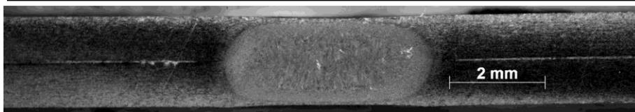
Abbildung 97: Querschliff der Schweißprobe 5M\_I4,8kA\_P0001,  $I_w = 4,8$  kA,  $F_e = 3,0$  kN,  $t_w = 480$  ms
