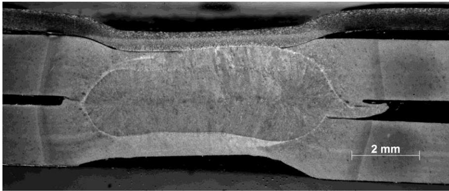
Abbildung 52: Querschliff der Schweißprobe 2RSW\_I8,0kA\_P0006,  $I_w = 8,0$  kA,  $F_e = 3,5$  kN,  $t_w = 1000$  ms
