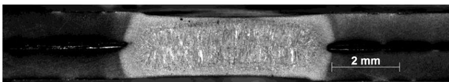
Abbildung 42: Querschliff der Schweißprobe 1M\_8,8kA\_P0001,  $I_w = 8,8$  kA,  $F_e = 2,7$  kN,  $t_w = 240$  ms
