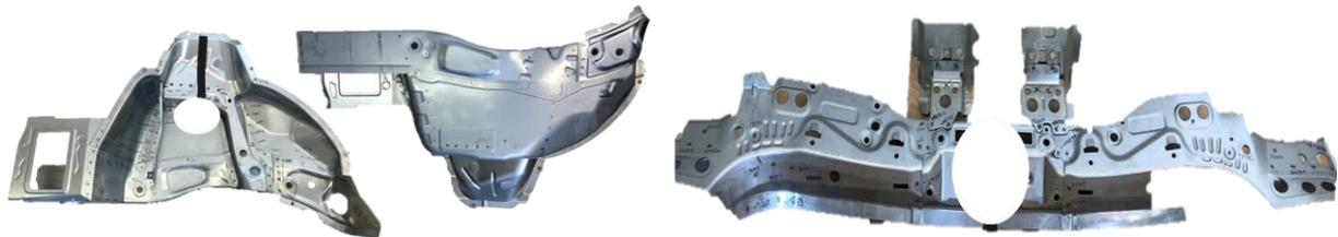
Abbildung 127: Serienbauteile zur Untersuchung der Anwendbarkeit der bildgebenden Analyse der Remanenzflussdichte
