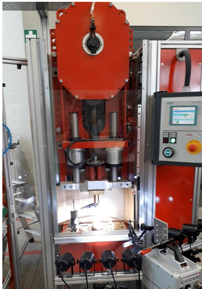
Abbildung 10: Maschine 1 mit Kurbeltrieb und aufgebauter Hochgeschwindigkeitsaufnahmen
