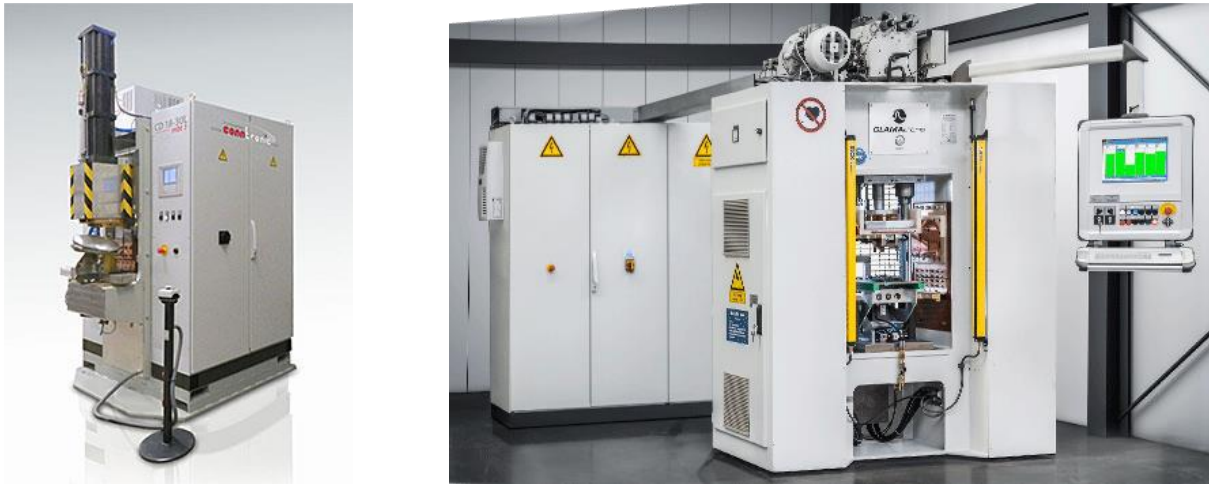
Abbildung 4: C-Gestell mit pneumatischem Antriebssystem (links) [25] und Portalgestell mit hydraulischem Antriebssystem [26]
