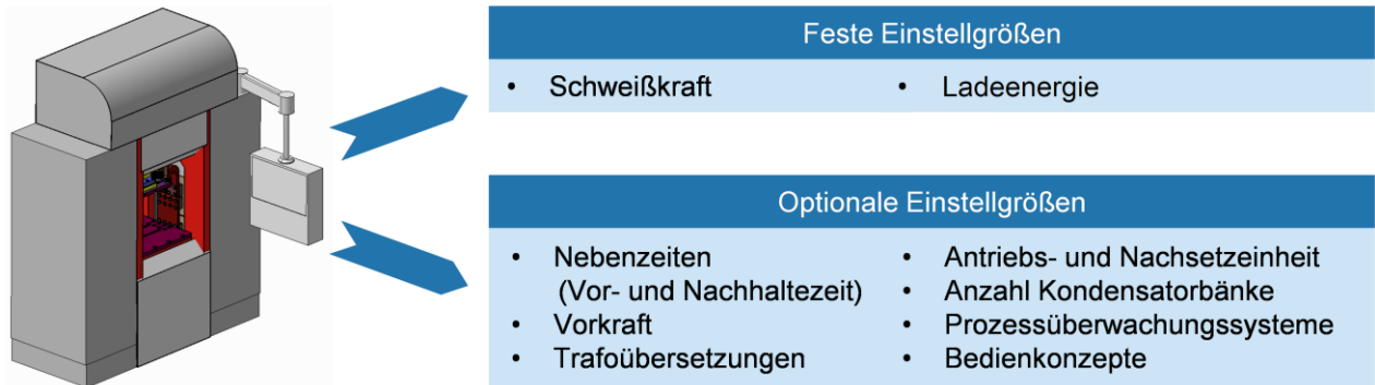
Abbildung 9: Einstellgrößen an einer Kondensatorentladungsschweißanlage [6]
