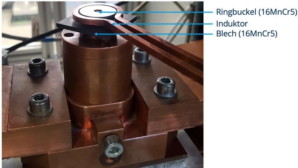
Abbildung 25: Experimenteller Aufbau zur Induktionserwärmung
