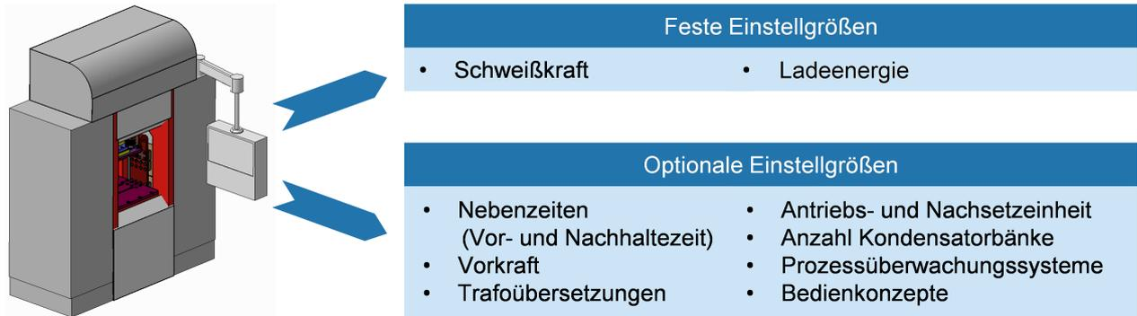
Abbildung 9: Einstellgrößen an einer Kondensatorentladungsschweißanlage [2]
