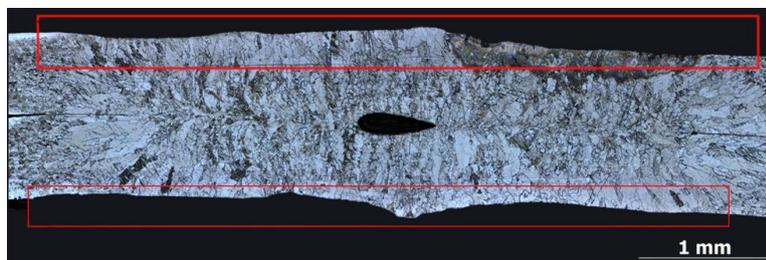
Abbildung 67: VR02 Verbindung mit ungleichmäßigem Elektrodeneindruck und einer Pore in der Linsenmitte (e2, Schweißpunktnummer 2000)
