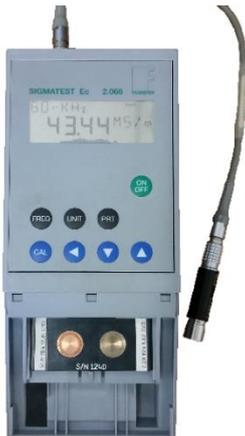
Abbildung 14: Wirbelstrommessgerät SIGMATEST 2.068
