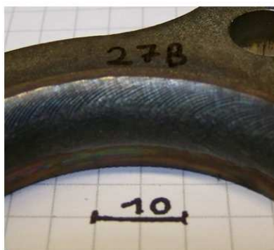
Abbildung 4-47: Maximal erreichbare Schweißgeschwindigkeiten bei Blech-Rohr-Verbindung (oben: Rein-Ar, unten ArHe mit 70 % He)
