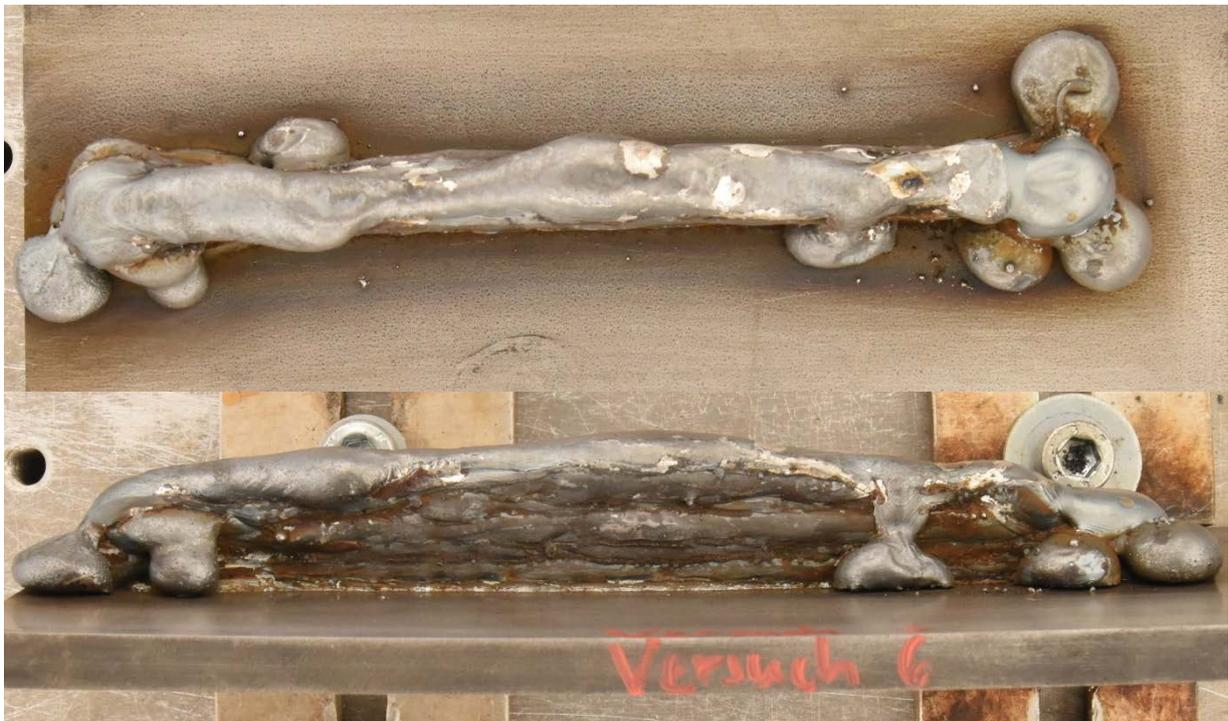
A- 19: Draufsicht und Seitenansicht zu Versuchen zum Aufbau von Wandstrukturen mit MSG-Heißdraht
