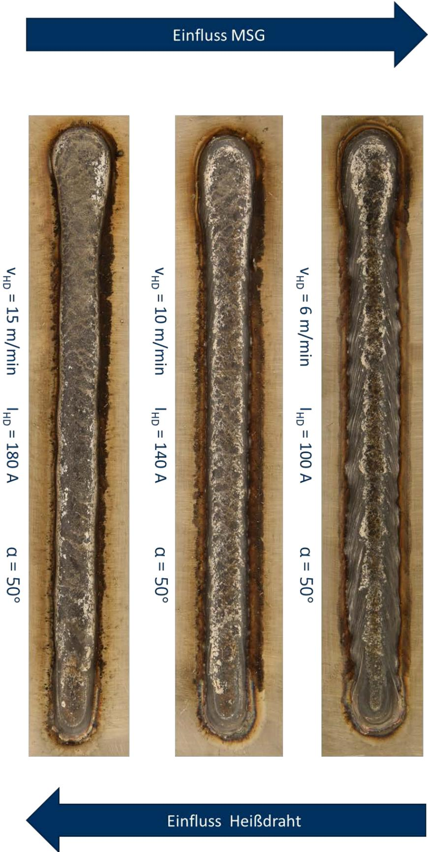
Abbildung 5-10: Äußere Nahtgeometrie für ausgewählte Schweißversuche mit 1.4301
