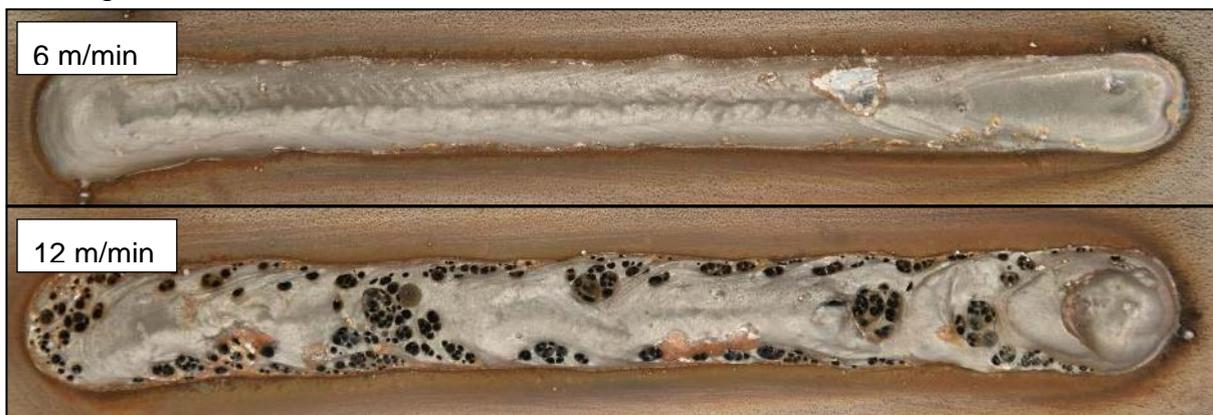
Abbildung 7-12: Schweißnaht bei einem steilen Anstellwinkel
