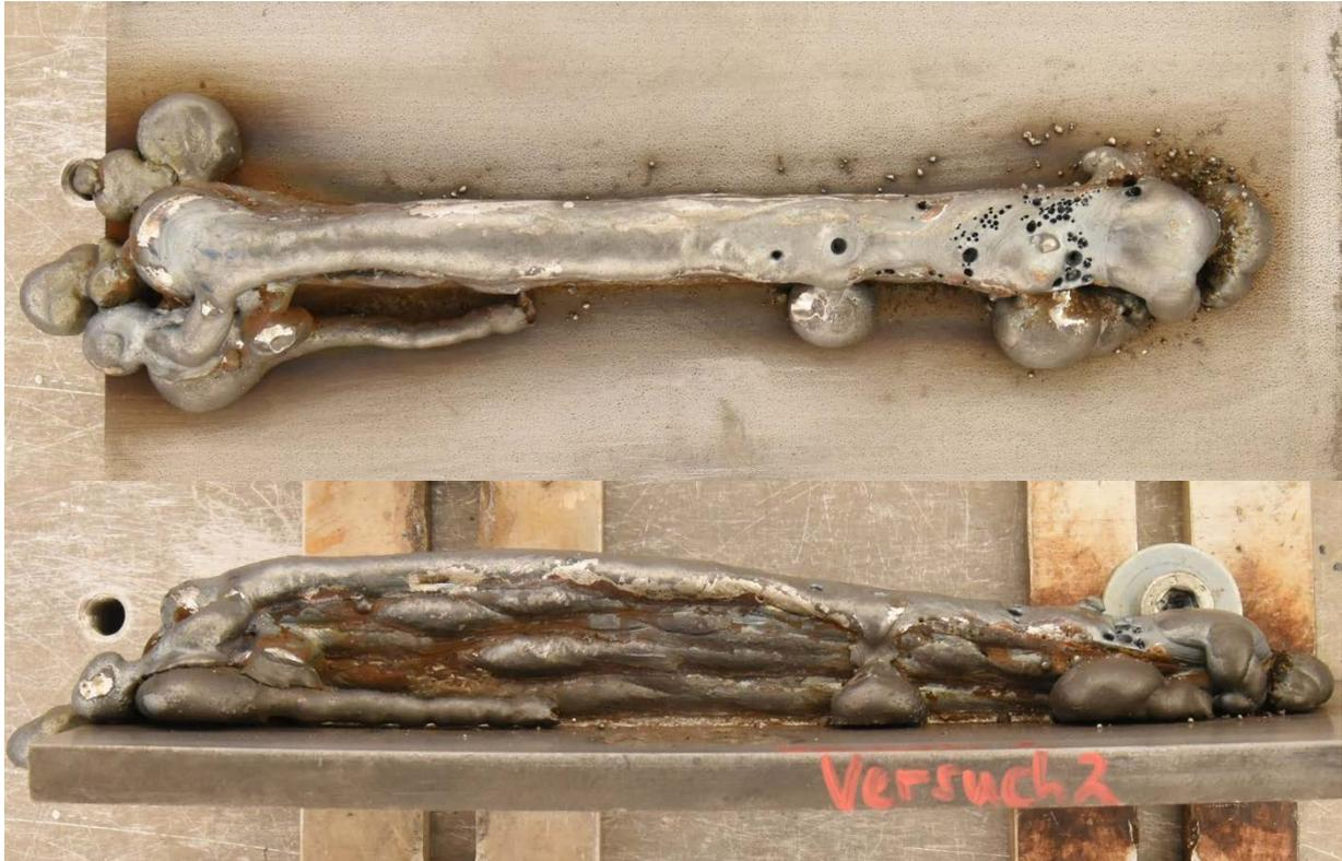
A- 18: Draufsicht und Seitenansicht zu Versuchen zum Aufbau von Wandstrukturen mit MSG-Heißdraht
