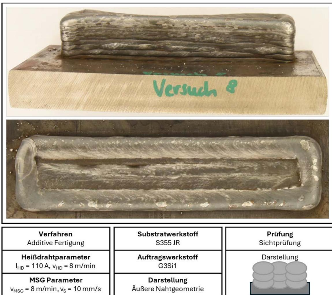
Abbildung 8-8: Mittels MSG-Heißdrahtprozess hergestellte Blockstruktur
