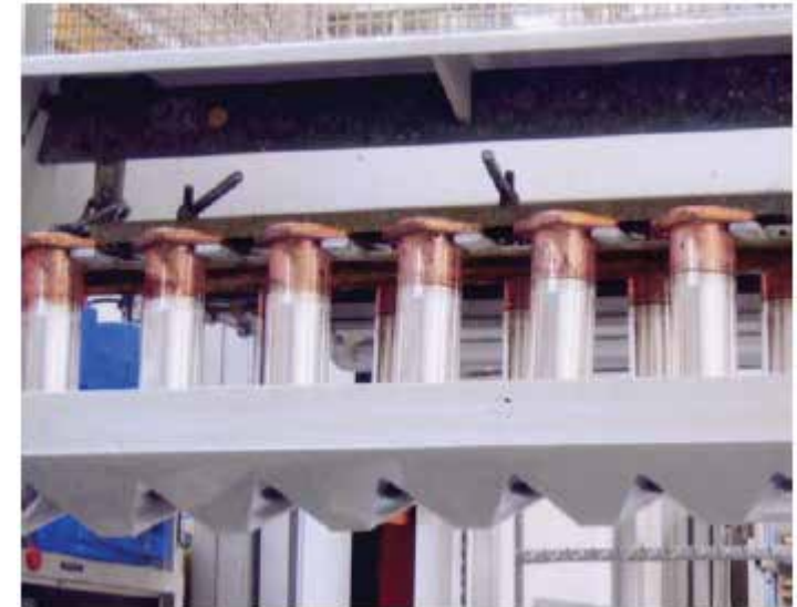
Abschirmvorrichtungen im Siemens-Schaltwerk zur partiellen Versilberung von Kontaktrohren
