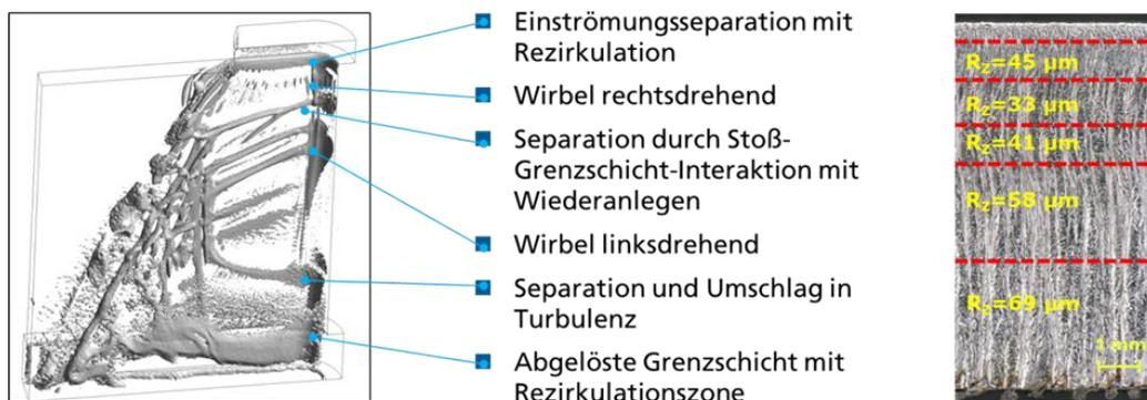
Abbildung: Simulierte Wirbelstruktur der Schneidgasströmung (links) und charakteristische Schnittkantenzonen beim Laserstrahlschmelzschnneiden von Stahl 1.4301 (rechts).
