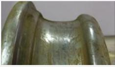
Neben dem Energieverbrauch und der Zugkraftausnutzung ist die Reprofilierungsrate der Räder ein wichtiger Faktor für die Wirtschaftlichkeit eines Schienentriebfahrzeugs. Speziell unter extremen Winterbedingungen wird in der Praxis ein signifikant erhöhter Radverschleiß beobachtet. Die Identifizierung der verschleißtreibenden Mechanismen im Rad-/ Schiene-Kontakt unter subarktischen Bedingungen ist Ziel des Projekts iceWEAR.
