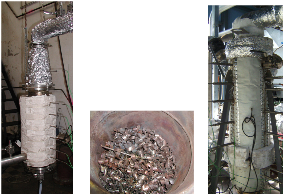
Bild 2: Reaktoren zur katalytisch partiellen Oxidation und Katalysatorschüttung
