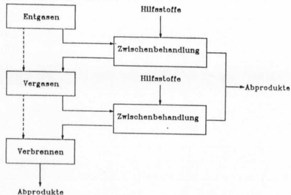
Bild 10: Schematische Darstellung einer Aufteilung der Prozessstufen Entgasung, Vergasung mit jeweils zwischengeschalteten Prozessstufen
