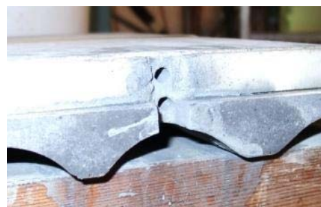
Abb. 11. JuSyS ® SL-Platte mit Bohrungen zur Bestimmung des Temperaturgradienten in der Platte.
