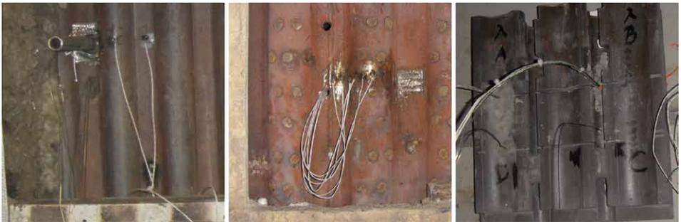
Bild 6: Aufbau und Anordnung der Messsensoren
