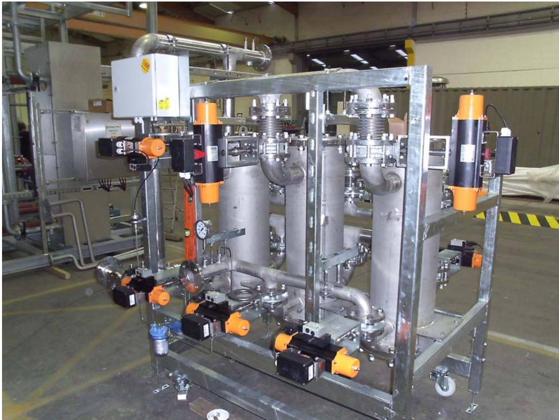
Abbildung 5: Versuchsanlage zur Erprobung der katalytisch partiellen Oxidation von Teeren mit einem kombinierten Katalysator-Sauerstoffträgersystem
