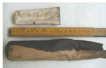
Extraktionshülsen nach Probenahme vor und hinter Gasaufbereitung
