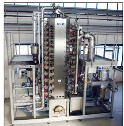
Bild 2 50-kW-Staubfeuerungs-Versuchsanlage für Oxyfuel
