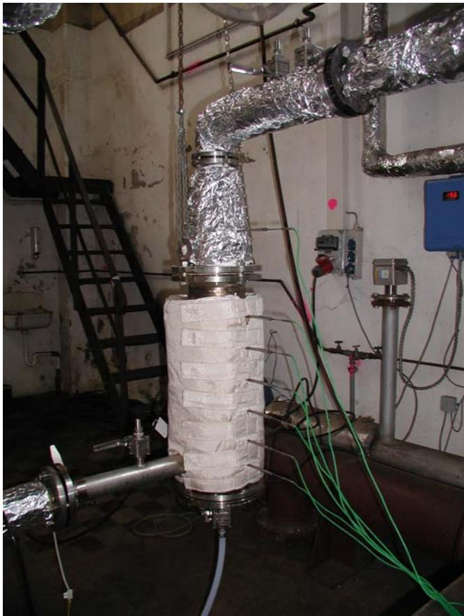
Bild 2: Kleintechnischer Versuchsreaktor zur katalytisch partiellen Oxidation der Brenngase
