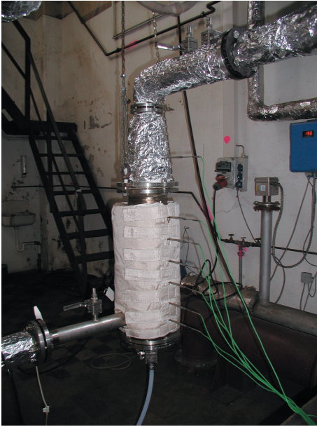
Bild 3: Kleintechnischer Versuchsreaktor zur katalytisch partiellen Oxidation der Brenngase
