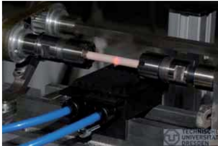
Abbildung 9: Versuchsstand zum Laserfügen (Professur für Wasserstoff- und Kernenergietechnik, TU Dresden).
