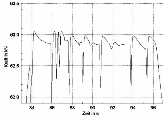
Wirkung und Mobilität der Organik, Abreißen des Formkörpers von der Matrize, verbleibende Restspannungen, Kraftverlauf beim Ausstoßen
