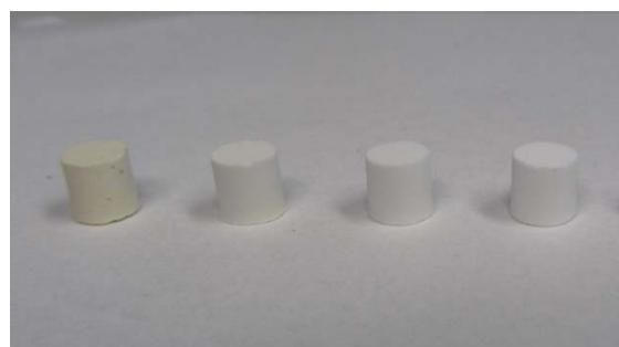
Abb. 2: LATP-Probenkörper, im Grün-zustand (linke Probe) und nach Sinterung.
