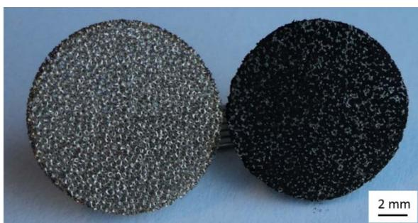
Abb. 1: Schaumkathode, hergestellt durch Infiltration eines Ni-Schaums mit Schlicker.
