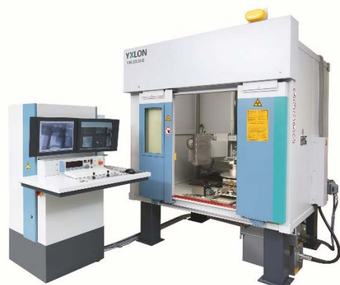
Abbildung 2: Röntgengrobstruktureinheit MU.2000-D der Firma YXLON International GmbH
