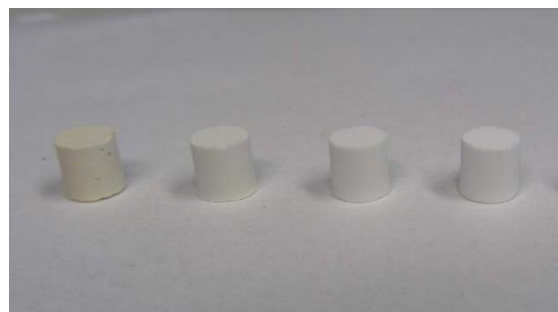
Abb. 4: LATP-Probenkörper, im Grün-zustand (linke Probe) und nach Sinterung.
