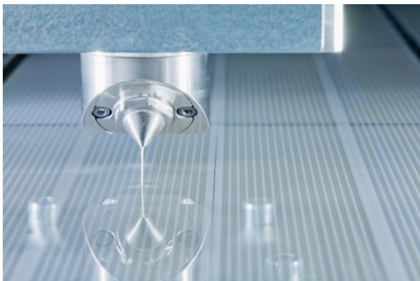
Bild 1: Faserablage ins Fällbad (Faserspinnanlage am IfWW) [Bildquelle: FhG IKTS Dresden]
