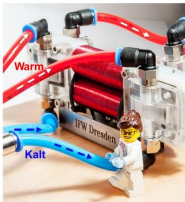
**Abbildung 1: Foto unseres thermomagnetischen Generators (TMG), der Niedertemperatur-Abwärme in elektrische Energie umwandelt.** Als aktives Material wird ein thermomagnetischer Werkstoff basierend auf La-Fe-Co-Si verwendet, das eine hohe und abrupte Änderung der Magnetisierung knapp oberhalb von Raumtemperatur aufweist. Der thermomagnetische Werkstoff wird durch Wasser abwechselnd aufgeheizt und gekühlt.
