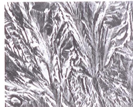
**Bild 118:** Federartige Oberfläche eines aufgebrochenen Risses, Spannungsrißkorrosion in chloridhaltigem Mittel
