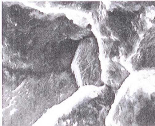
**Bild 116:** Mit Korrosionsprodukten belegte Korngrenzflächen, Zerstörung durch Laugenangriff, kohlenstoffarmer Stahl
