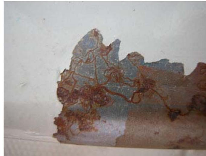
Luftfeuchtigkeit dringt durch Schwachstellen in der organischen Beschichtung zum unlegierten Stahl vor. Dies kann durch schlechte Vorbereitung der Metall-Oberfläche noch begünstigt werden. Die Korrosion schreitet unter der Beschichtung fadenförmig fort. Durch das größere Volumen des Korrosionsproduktes platzt die Beschichtung letztlich ab.
