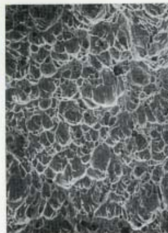
Bild 3a: Waben (Dimples). Transkristalliner Gleitbruch
