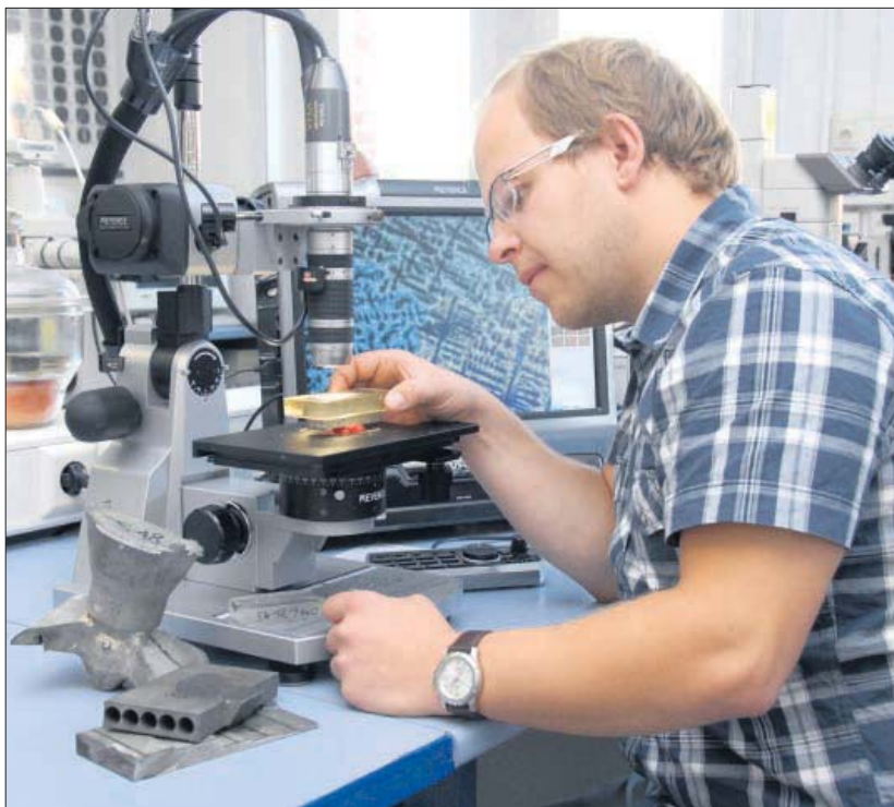
Doktorand Mario Tränker analysiert am Lichtmikroskop (Metallografielabor im Berndt-Bau) ein Gussgefüge.
