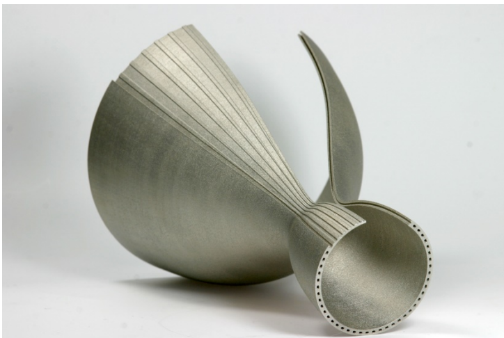
Turbinendemonstrator - hergestellt mit SLM, Fraunhofer IWS/TUD
