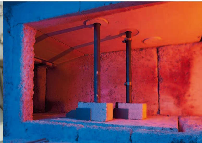
◀ *Heißgasversuchsstand. Hier werden die Wärmerohre unter Realbedingungen getestet.*
