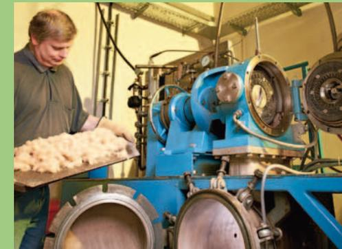
▲ *TMP-Anlage (Thermo Mechanical Pulp) zum Aufschließen der Pflanzenfasern.*
