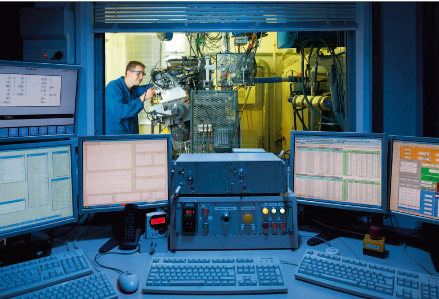
*Im Motorenprüfstand werden die beschichteten Motorenteile unter Realbedingungen getestet.*
