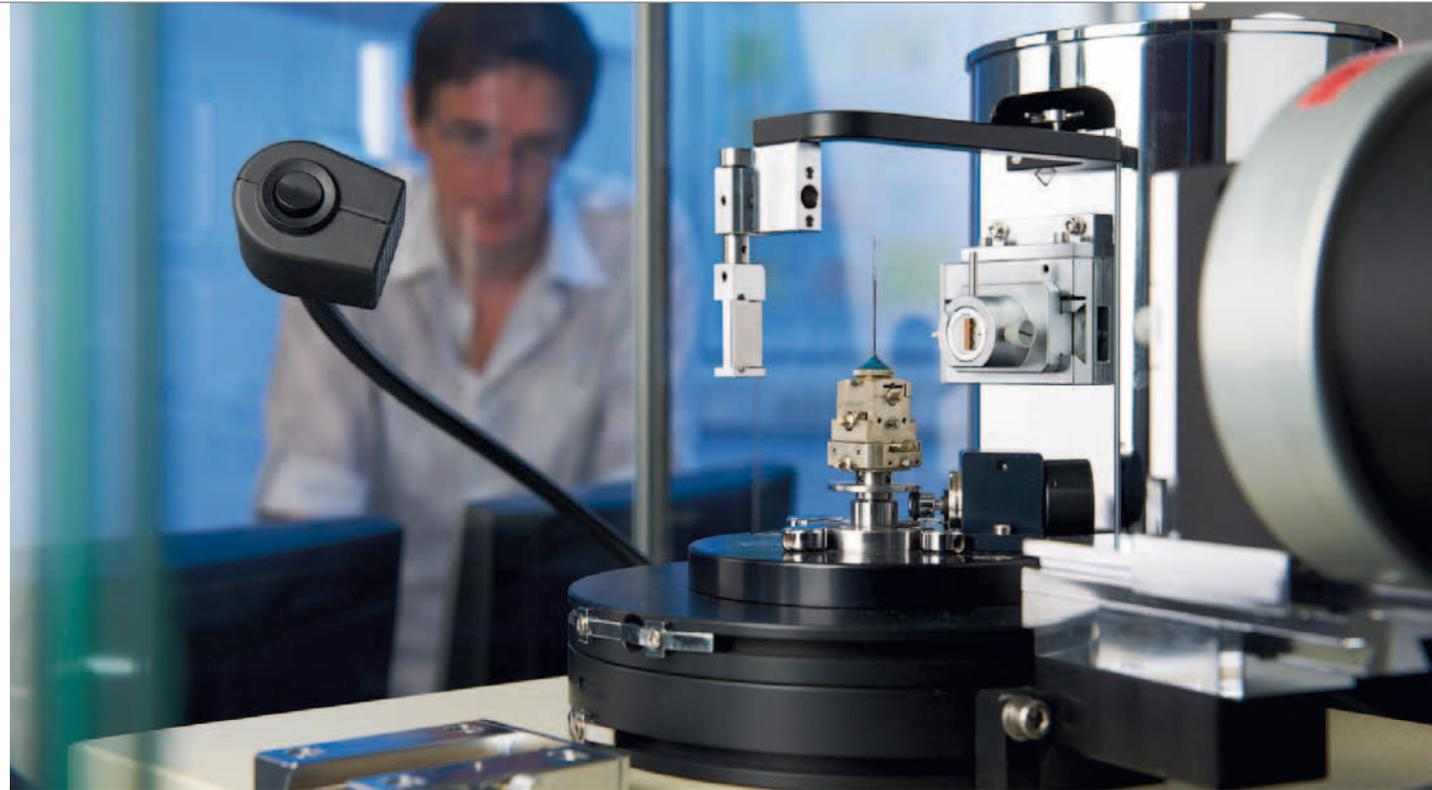
▲ Röntgengerät zur Materialbestimmung mit Justierung einer luftdicht verschlossenen Probe.
