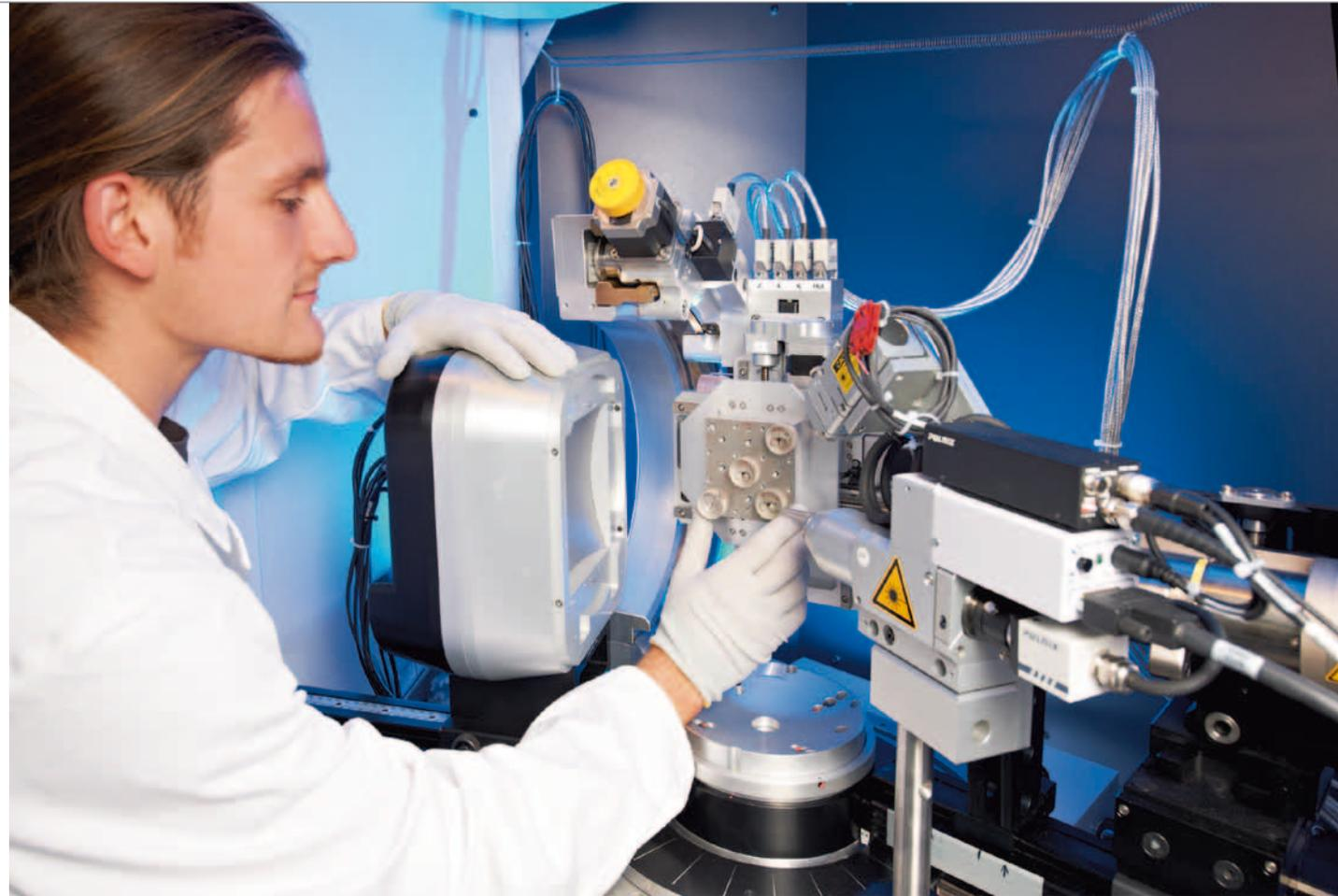
▲ Mikrodiffraktometer zur Analyse der ultrafeinkörnigen Gefüge.
