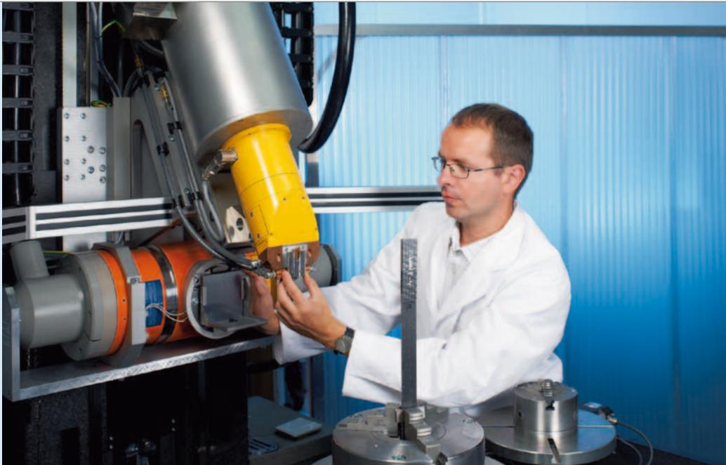
mit sehr unterschiedlichen Wärmeausdehnungskoeffizienten und für besonders wärmeempfindliche Materialpaarungen. Die RMS-Technik ist damit auch zum Fügen von thermoplastischen Faser-Kunststoff-Verbunden prädestiniert. Die derzeit angewandten Fügeverfahren schädigen mitunter die Fasern und Matrices und mindern die Festigkeiten der Verbundwerkstoffe oder sind – wie zum Beispiel beim Kleben – aufgrund der häufigen Unpolarität der Klebstoffe nur unter großem Aufwand anwendbar.
