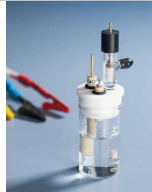
◀ Elektrochemische 3-Elektroden-Testzelle für Superkondensatoren.
