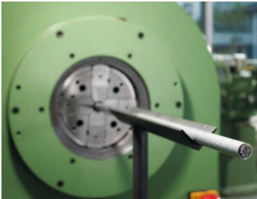
▲ Rundhämmermaschine zum Herstellen der ultrafeinkörnigen Drähte.
