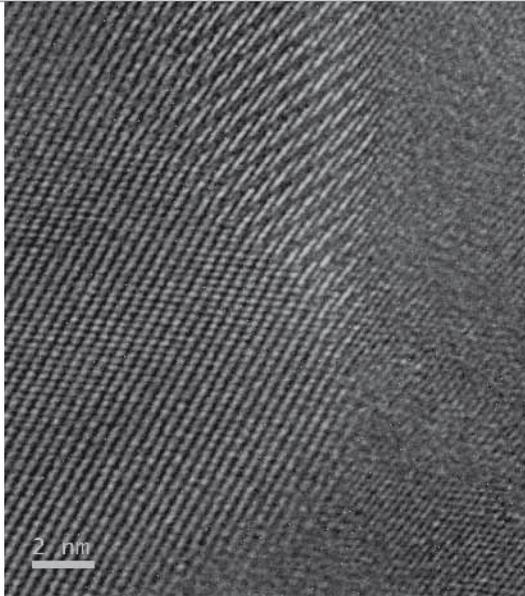
▲ Elektronenmikroskopische Aufnahme einer Borcarbidstruktur mit Korngrenze (HRTEM-Bild).
