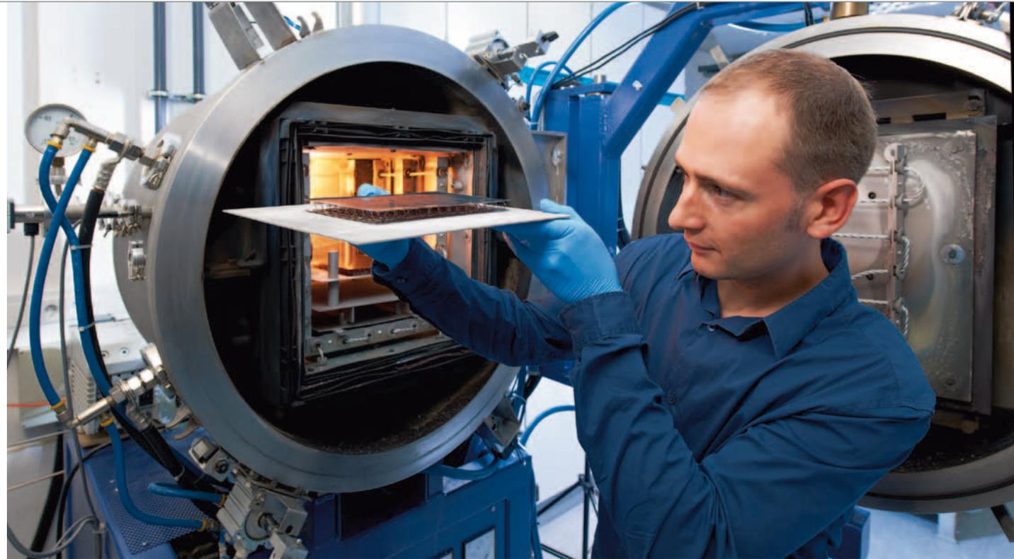
▲ Lötöfen zum Fixieren der Drähte in der Struktur und zur Herstellung der Sandwichverbunde.
