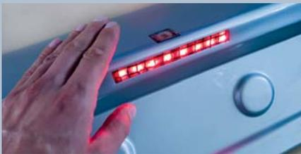
Den im Projekt TEMAG entwickelten Fertigungsprozess demonstrieren die Forschungspartner am Beispiel einer Fahrzeug-Heckklappe. Diese wurde mit einem Touch-Sensor und einer Bremsleuchte ausgestattet. ■ This tailgate with an integrated touch sensor and brake light demonstrates the manufacturing process developed as part of the TEMAG project.
