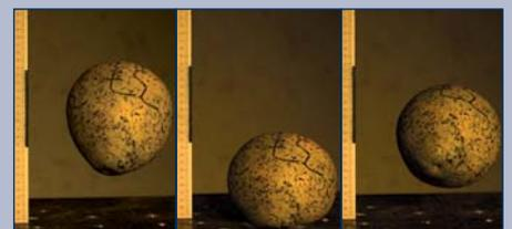
Aufgezeichnet mit einer Hochgeschwindigkeitskamera: Fallversuche an Pomeles. In der Natur fallen diese Früchte ohne Beschädigung von bis zu 15 m hohen Bäumen.
