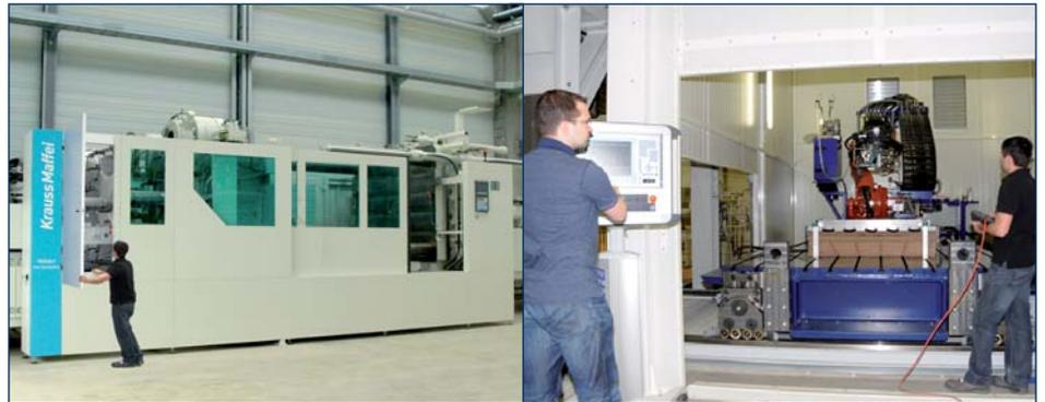
Links: Zwei-K-Spritzgießanlage (2300 t Schließkraft). Rechts: LFI-Anlage mit Werkzeugshuttle.
