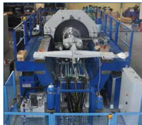
Im BMWi-Projekt HYDROS entstand dieser neue Schwerlastprüfstand für Schiffswellenlager am ILK.
