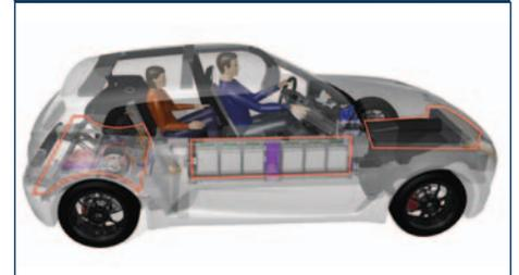
Der ultraleichte InEco im sportlichen Design mit Elektroantrieb (o.) und crashtsicher integriertem Batteriesystem (u.).
