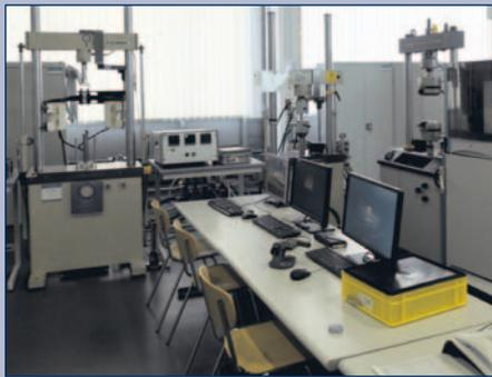
Werkstofflabor für die Werkstoffcharakterisierung bei einachsiger zyklischer Belastung mit überlagerter Temperatur- und Medieneinwirkung.
