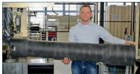
Projektleiter Dr.-Ing. A. Ulbricht mit der innovativen CFK-Schwerlastgelenkwelle in hochintegrativer Leichtbauweise.
