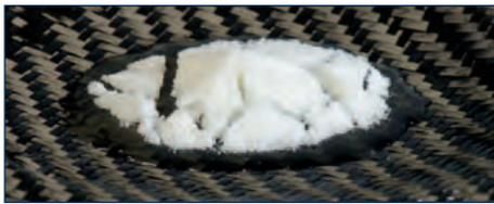
Ein neues pulverförmiges Epoxidharz ist Basis für zwei innovative und effiziente Verfahren zur schnellen Herstellung duroplastischer Hochleistungs-Faserverbundbauteile.
