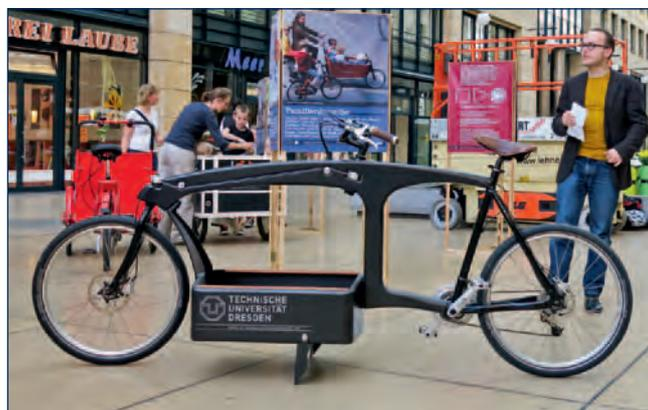
Am ILK entwickeltes Lastenrad in CFK-Hybridbauweise.
