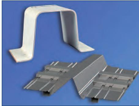
Für die Grundstruktur des Demonstrators aus dem Leika-Projekt konzipierten die Wissenschaftler den Sandwichaufbau mit Stahldecklagen und die Sitzquerträger aus einem Sandwichverbund mit Magnesiumdecklagen.
