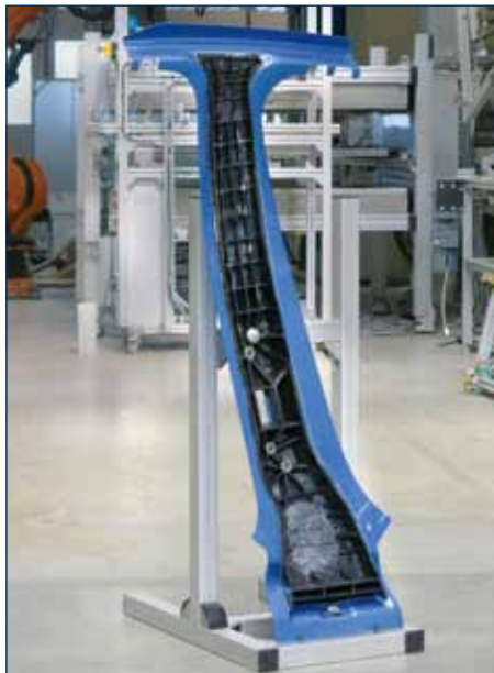
Hochintegrierte B-Säule aus metallischen Komponenten und Faserverbundwerkstoffen.
