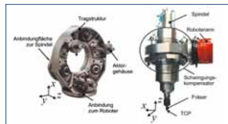
Prototypischer Schwingungskompensator und dessen Montage am Industrieroboter
