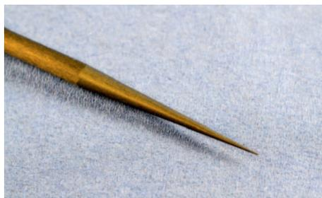
Im Projekt **MINDENDO** untersuchen die Forscher vergleichend das Schwingungsverhalten faserverstärkter und konventioneller Instrumentenspitzen für verschiedene Materialkonfigurationen in Zahnwurzelkanalmodellen.
