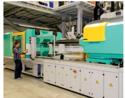
Die von ARBURG zur Verfügung gestellte Spritzgießmaschine vervollständigt mit 500 Tonnen Schließkraft und 920 Millimeter Säulenabstand den Maschinenpark des ILK optimal. Sie wird zur Prozessentwicklung in den FOREL-Vorhaben FuPro und SamPa eingesetzt.
