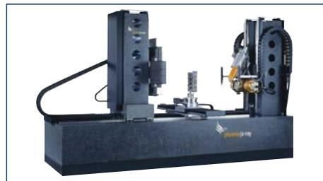
Der Multi-Scan-Computertomograph ermöglicht die zerstörungsfreie Prüfung von Großstrukturen.
