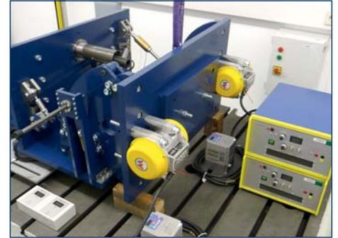
Versuchsaufbau für aktive Schwingungsminimierung an Triebwerksaufhängungen durch „aktive“ Multifunktionsstreben.
