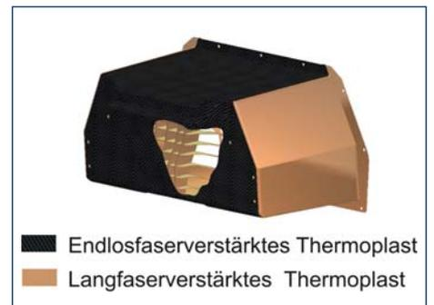
■ Endlosfaserverstärktes Thermoplast
