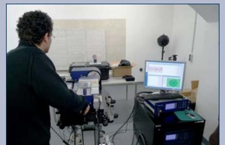
Derotator mit Laser-Scanning-Vibrometer im Einsatz.
