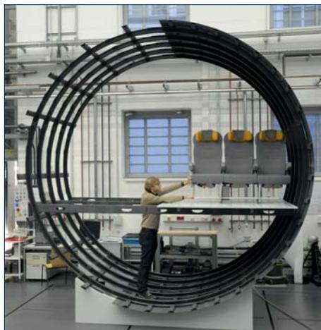
Neuer Flugzeugrumpf-Prüfkomplex in CFK-Bauweise.
