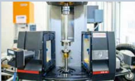
Eine neue Feuchtigkeitsmesszelle am ILK erweitert die Möglichkeiten zur Charakterisierung von Polymeren.
