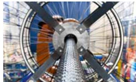
Am ILK steht für die flechttechnische Verarbeitung von Tape-Halbzeugen eine eigens entwickelte Anlagentechnik zur Verfügung, welche die gleichzeitige und automatisierte Ablage von bis zu 576 Einzeltapes in einem Flechtvorgang erlaubt. Damit können endkonturnahe Preforms von bis zu drei Metern Durchmesser hergestellt werden.
