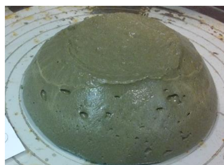
Ausbreitversuch mit Schaumbeton
