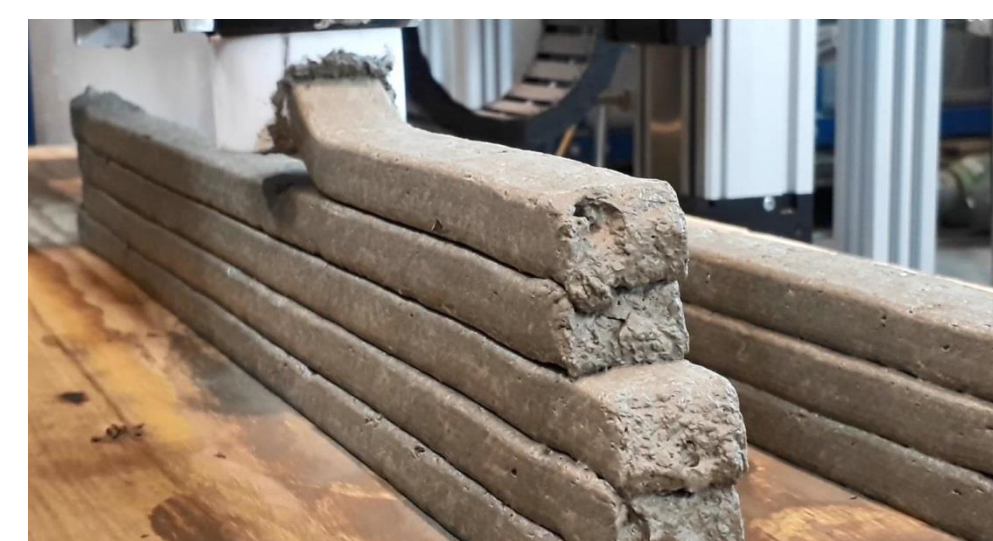
Druck eines Probekörpers aus Schaumbeton
