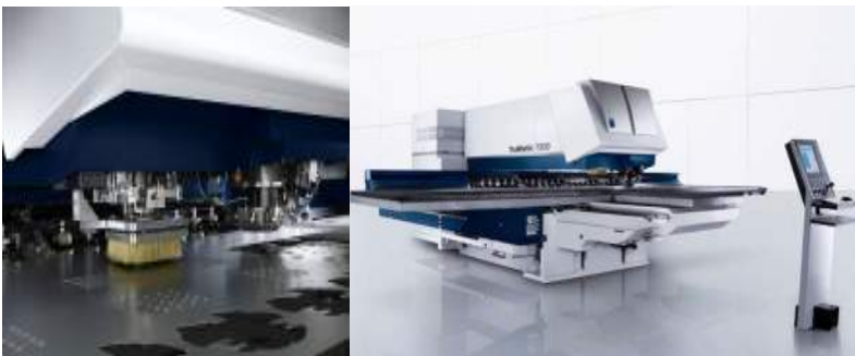
Bild 5: Kombinierte Achsen beim Stanz-/Nibbel-/Laser- Kombibearbeiten
