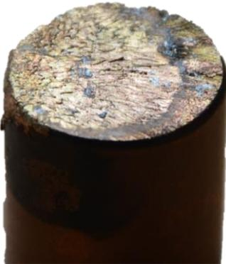
*Verschlossene Elektrodenkappe (links), Versuchsstand zum Widerstandspunktschweißen (rechts)*
