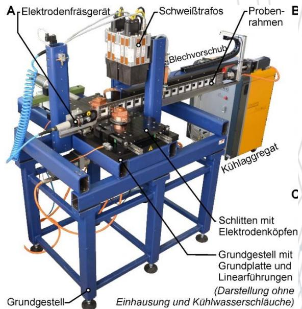
*verschlossene Elektrodenkappe (links), Versuchsstand zum Widerstandspunktschweißen (rechts)*
