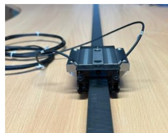
Bild 2: Profilschienenführung mit integrierten Sensoren
