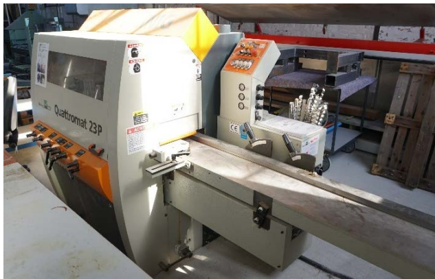
Abb. 1: Versuchsmaschine Typ Weinig Quattromat 23 P (links); schematische Darstellung zusätzlicher Sensorik (rechts)
