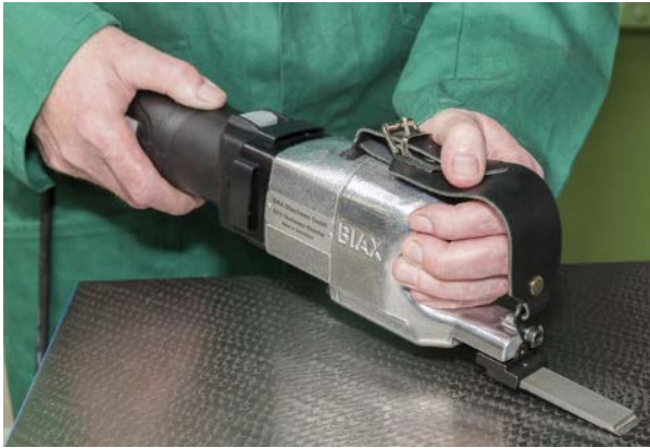
Abb. 1: Links: Manuelles Schaben mit Elektroschaber ( https://www.biax-germany.com/biax/produkte.php?category=schaber )
