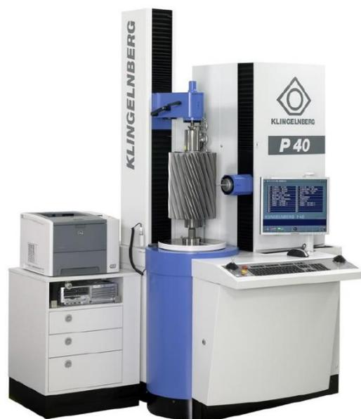
Am IMM haben wir ein CNC gesteuertes Präzisionsmesszentrum, mit dem u.a. auch Stirnräder vermessen werden können. Neben Rauheiten und der Teilung spielt die Profilformabweichung eine entscheidende Rolle, um den Verschleiß von Zahnrädern genau zu charakterisieren. Dafür wird ein Zahnrad nach vorher festgelegten Laufzeiten mehrmals vermessen. Anhand der Messwerte kann dann die Veränderung und der Verschleiß genau beschrieben werden.
