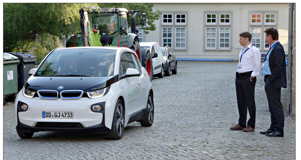
Der neue BMW i3 mit elektrischem Antrieb beeindruckt mit technischen Daten: 75 kW bei 4800 U/min (125 kW Spitze) und 250 Nm Drehmoment sorgen für eine enorme Beschleunigung.
