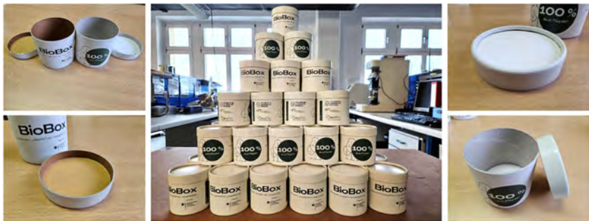
Abb. VIII-31: Prototypen-Serie der BioBox – eine biogene und recyclingfähige Verpackung mit ausgewählten Barriereigenschaften aus 100 % Papier
